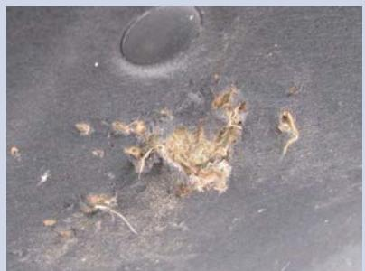
Podvozje i oplata odjeljka motora s napuklinama. Štete nastale od ugriza životinja (kuna).
