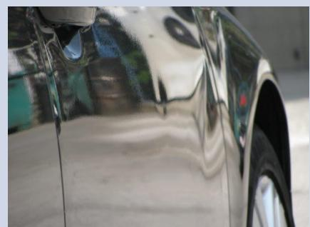
Udubljenja nastala udarom kamena, koja nisu veća od promjera 1 cm ili do 3 udubljenja na  $1\text{dm}^2$  na prednjem dijelu vozila.
