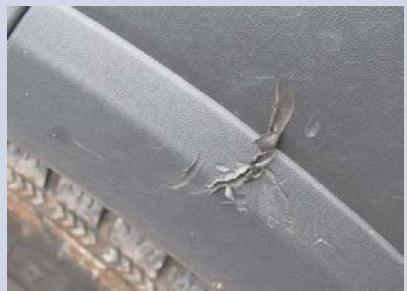
Nelakirani plastični dijelovi s ogrebotinama ili udarcima, odnosno s deformacijama i napuklinama, te zahtijevaju zamjenu.
