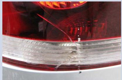
Ostakljenje i dijelovi svjetala koji propuštaju vodu, oštećeni su ili slomljeni i/ili imaju nedostatke.
