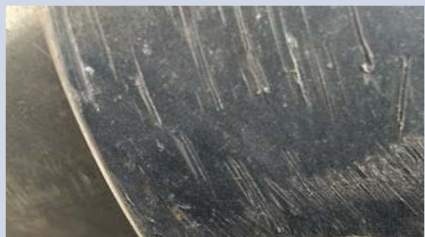
Podvozje i oplata odjeljka motora s izgrebenim mjestima i bez napuklina.
