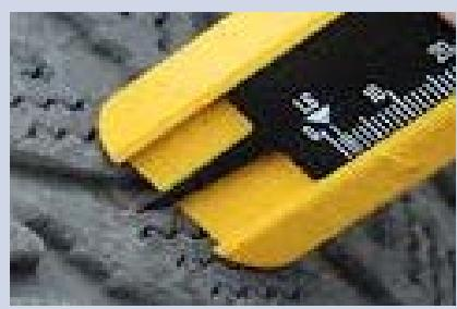
Gume s oštećenjem (izbočine, rezovi ...) ili jednostranom istrošenosti. Gume koje više ne jamče potrebnu sigurnost u prometu, odnosno imaju profil manji od minimalno dopuštena 2 mm odnosno 4 mm. Ako su montirane zimske gume, moraju biti dostavljeni originalni naplatci s odgovarajućim ljetnim gumama.
